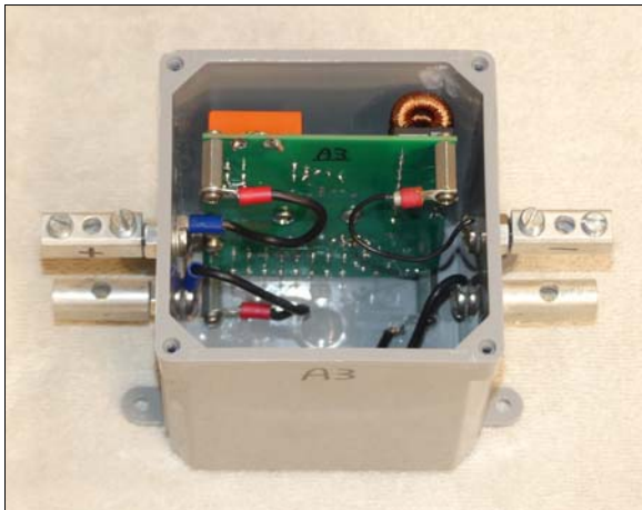
Figure 30 - A3 Relay Module Interior (1)
